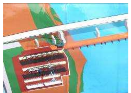
旧高橋の鉄骨取り外し図
