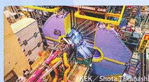
日本最大の粒子加速器SuperKEKBの 衝突点付近のBelle II測定器
