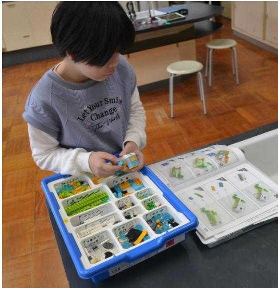
6年生の理科では、MESHを用いたプログラミング学習に続き、レゴエデュケーションが開発した教材「WeDo2.0」を活用した学習に取り組みました。今回は、WeDo2.0でスイッチロボットを制作し、人感センサーの反応をきっかけに、コンデンサーを電源とした豆電球を点灯させる実験に挑戦しました。
